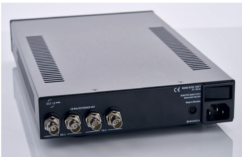
Die Taktausgänge des REF 10 NANO: 2 x BNC 50  $\Omega$  und 2 x BNC 75  $\Omega$ . Wenn man genau hinschaut, erkennt man, dass der Innenteil der 50  $\Omega$  und 75  $\Omega$  Buchsen (weiße Isolierung) unterschiedlich ist
