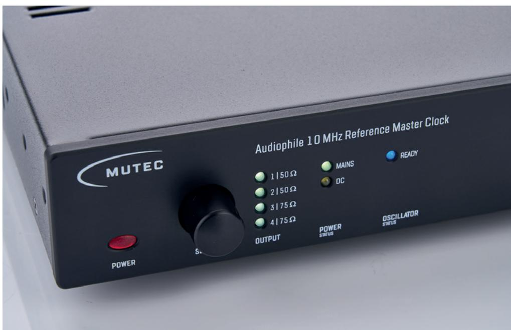
Mit dem schwarzen Drehknopf werden die Ausgänge an- oder abgeschaltet. Die blaue LED leuchtet dauerhaft, wenn der Aufwärmprozess des Oszillators abgeschlossen ist
