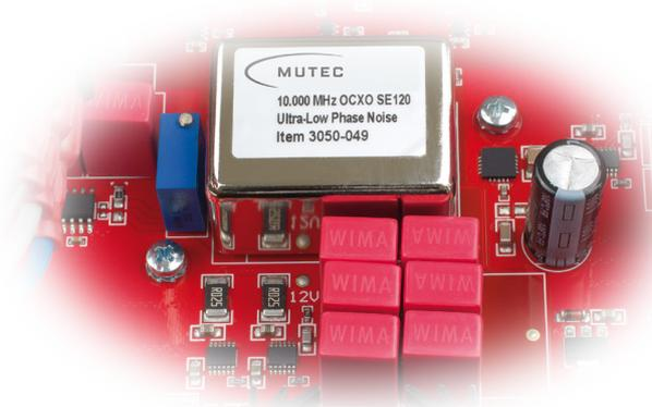
Diese im Herbst 2020 erschienene Spezialversion vom REF10 markiert die absolute Spitze im Bereich der 10-MHz-Referenztaktgeneratoren. Die technischen Werte des REF10 SE120 sind in Bezug auf Phasenrauschen und Jitter nach unserem Wissen derzeit branchenweit führend.
