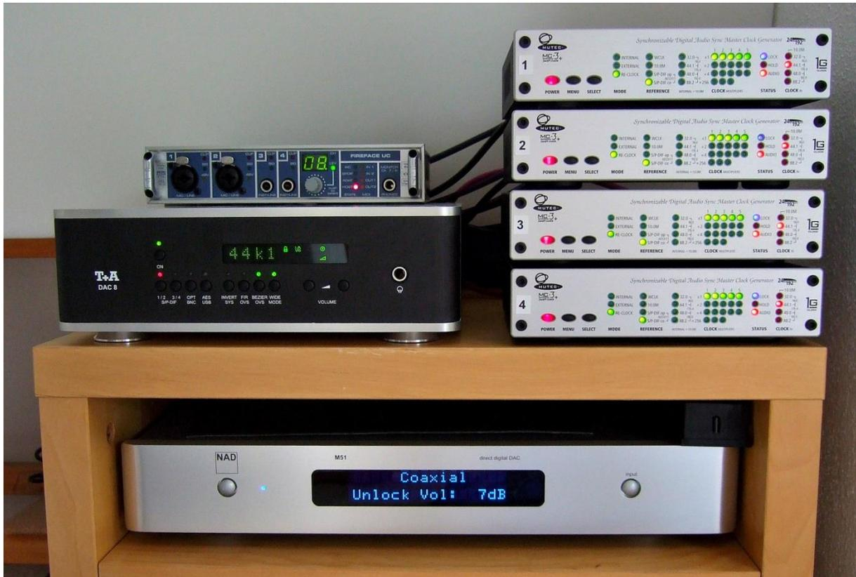
Nur kurz zur unterschiedlichen Konstruktion: Der NAD M51 arbeitet bis kurz vor den analogen Ausgangsbuchsen rein digital. Über einen sog. DDFA-Chip (Direct Digital Feedback Amplifier) der Firma Zetex empfängt der M51 seine PCM-Daten, rechnet sie in einen PWM-Bitstrom (lt. Hersteller mit 7bit / 844kHz) um, der wiederum mit Schalttransistoren verstärkt und zum Schluss mit einem flachen Tiefpassfilter behandelt wird.
